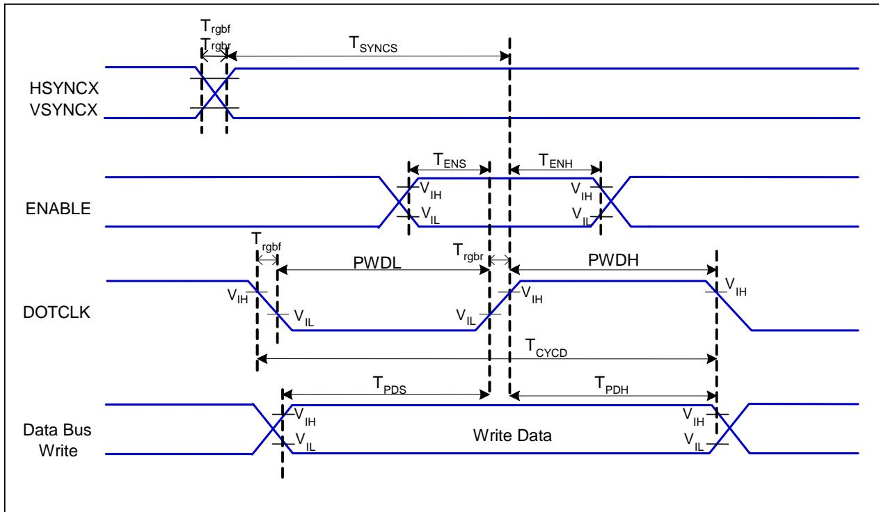
$VDDI=1.65$  to  $VDD$ ,  $VDD=2.5$  to  $3.3V$ ,  $AGND=DGND=0V$ ,  $T_a=25^{\circ}C$
