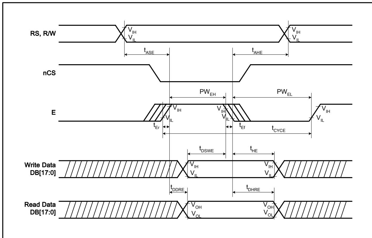
Figure74 M68-System Interface Timing
