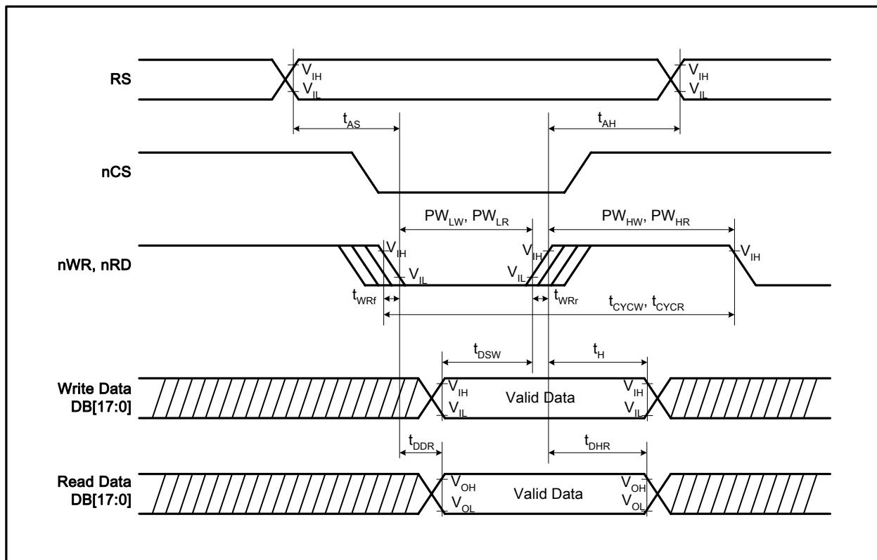
Figure 72 i80-System Bus Timing
