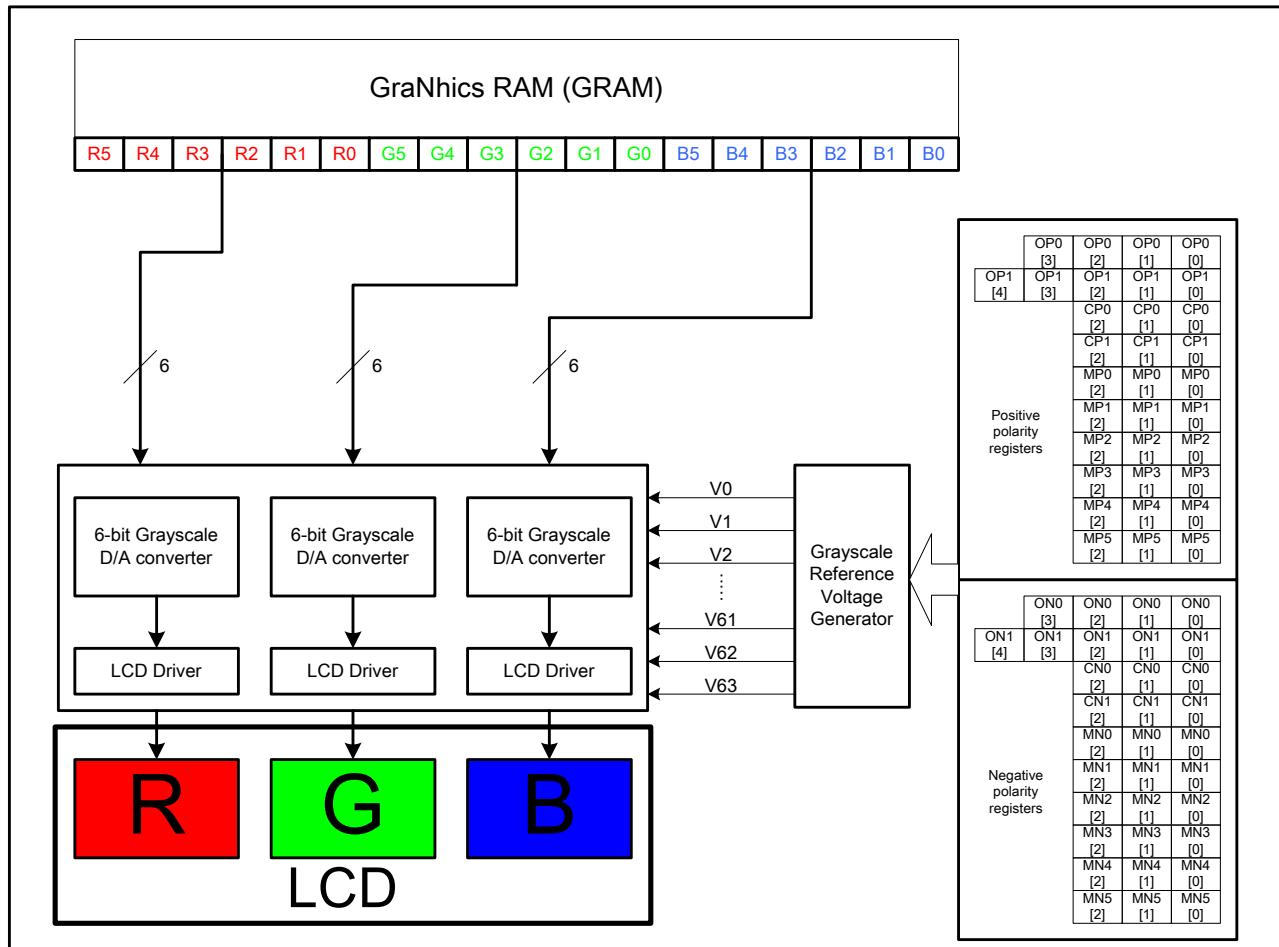
Figure 56 Grayscale Mapping
