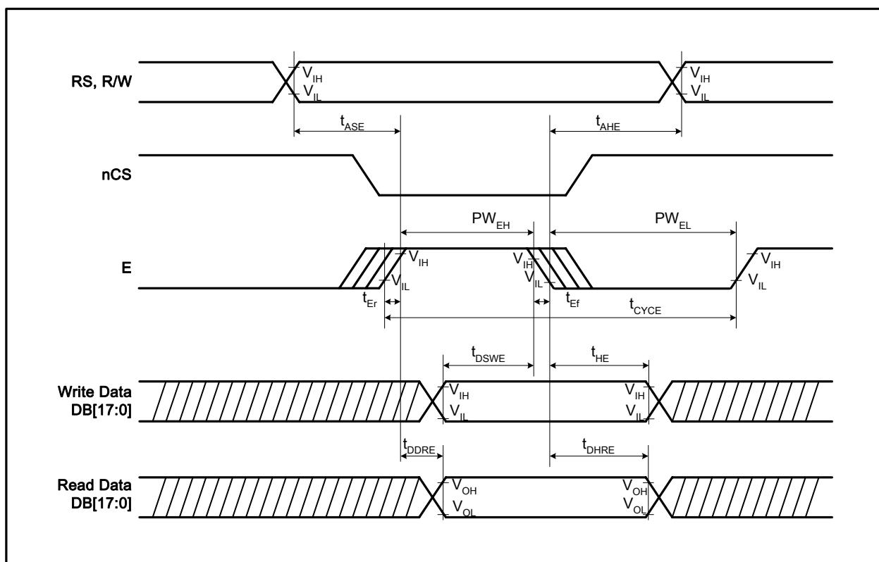
Figure 73 M68-System Bus Timing
